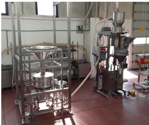
Перемещение гранул желатина Granules jelly conveying
